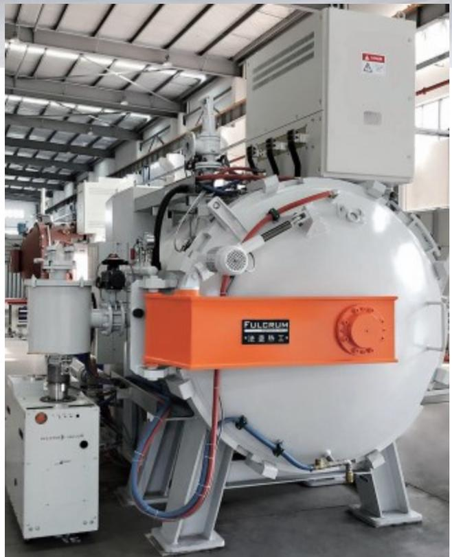
Ultra Heat™ 真空烧结炉 最高加热温度可达 2800°C;可用于金属/非金属的高温/超高温烧结以及石墨碳素材料的石墨化以及纯化处理
