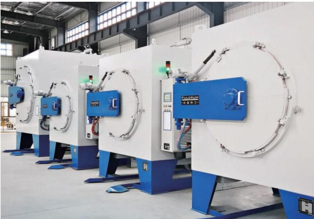
T(N)型预抽真空罐式回火炉带有可真空密封的耐热钢炉罐,可进行预抽真空并采用保护气体对流加热,该炉型设计成熟合理,自动控制先进可靠;可实现稳定、经济、高效的精密可控氮化处理、软氮化、后氧化、以及回火、退火等热处理。
